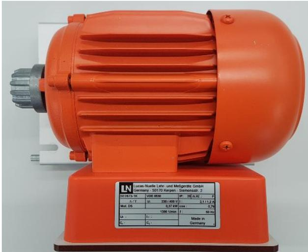
Le moteur à l'essai (ci-contre) ici est du type asynchrone à cage d'écureuil. Les caractéristiques sont reprises sur la plaque signalétique ci-avant.
